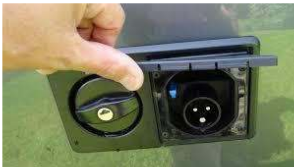
Aussenstromanschluss und Frischwasser-Wassereinfüllstutzen
